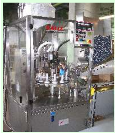
Тубонаполнительные машины французской фирмы «KALIX» для фасовки в пластиковую и ламинатную тубу
