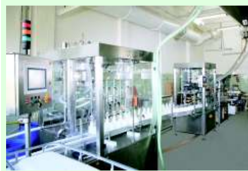
Автоматическая линия французской фирмы «РКВ» по фасовке косметических средств во флаконы
