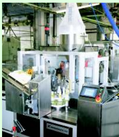
Тубонаполнительная машина шведской фирмы «Norden» Nordenmatic 402-DAS
