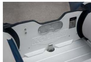
Кроме традиционного фанерного транца на надувные моторные килевые лодки «КОЛИБРИ» мы выпускаем стеклопластиковый композитный транец.
