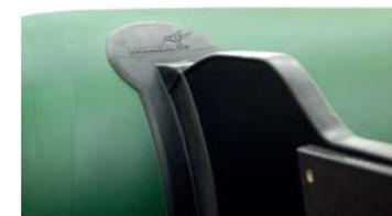
В отличие от традиционного способа крепления транца на надувные лодки – оклеивание тканью ПВХ, где крепеж обеспечивают две мягкие ленты ПВХ суммарной толщиной 1,8 мм с каждой стороны, **опора транца монолитная** – это единый монолитный крепежный элемент, изготовленный из поливинилхлорида с толщиной стенки у основания 6 мм.
