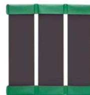
**Слань-коврик** – производится из влагостойкой фанеры толщиной 9 мм и имеет противоскользящее покрытие. Карманы сланей изготавливаются из ткани ПВХ и свариваются на установках ТВЧ, они защищают борта лодки от истирания.
