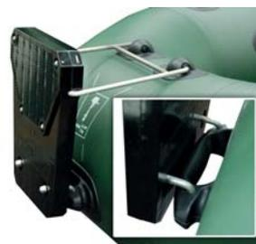
**Пластиковый навесной транец** крепится к баллону лодки при помощи оригинальной конструкции – нижняя опора, которой интегрирована в кормовую ручку для переноски лодки.
